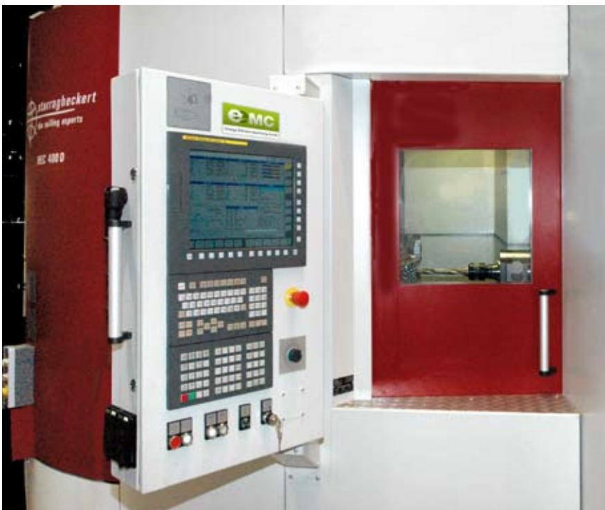
Zentraler Bedienplatz mit optimaler Sicht in den Arbeitsraum und schwenkbarem CNC-Tableau
