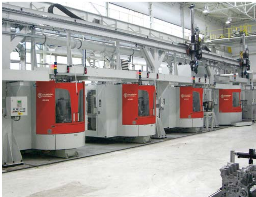
Fertigungslinie mit Bearbeitungszentren HEC 400 D und automatischem Werkstückhandling über Portalbeschickung für die Bearbeitung von Kurbelgehäusen
